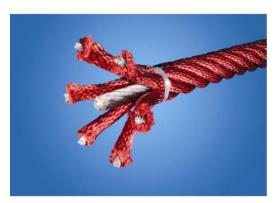
Веревки Corocord диаметром 19 мм и более это особый тип «Геркулес» с оцинкованными шестистрочными стальными проволоками. Каждая нить плотно обмотана нитью PES, которая расплавляется на каждую индивидуальную прядь. Веревки обладают высокой стойкостью к износу и устойчивостью к вандализму. При необходимости могут быть заменены на
