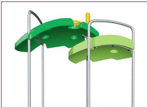
Крыши структур ELEMENTS изготовлены из перерабатываемого PE с минимальной толщиной стенки 5 мм, что обеспечивает высокую долговечность в любых климатических условиях по всему миру. Стальные трубы оцинкованы методом горячего цинкования внутри и снаружи для максимальной прочности.
