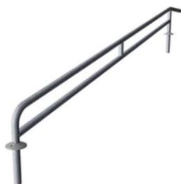
Высота перил составляет 930 мм, а расстояние между перилами 900 мм. Материалом, используемым для изготовления перил, является оцинкованная сталь диаметром 38 мм, что поддерживает хорошее сцепление, а также запястье в правильном положении.
