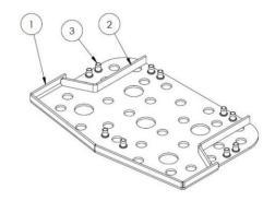
Внутри SBR отливается плита из оцинкованной углеродистой стали толщиной 5 мм, чтобы обеспечить оптимальную устойчивость и оптимизировать монтаж ступеньки к раме.
