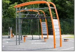
Для обеспечения целостности основной рамы основные опоры оранжевого цвета изготовлены из стальных стержней диаметром 101,6 х 3 мм, оцинкованы горячим способом и обработаны порошковым покрытием оранжевого цвета (RAL2010). Опорные стойки проходят одинаковую обработкуповерхности и изготовлены из стальных труб диаметром 76.1 х 3.6 мм с порошковым покрытием серого цвета (RAL7012).
