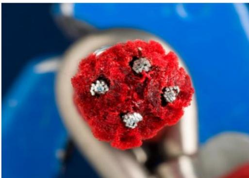
16-миллиметровые канаты Corocord - это специальный тип Геркулес с оцинкованной четырехжильной стальной проволокой и сердечником из стальной проволоки. Каждая прядь плотно обмотана нитью PES, которая расплавляется на каждую прядь. Веревки обладают высокой износостойкостью и устойчивостью к вандализму и при необходимости могут быть заменены на месте.
