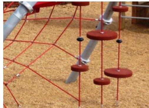
Полностью окрашенные резиновые диски EPDM с гладкой поверхностью. Формованный EPDM окружает стальной сердечник из горяче оцинкованной стали, который обеспечивает как стабильность дисков, так и долговечную фиксацию на канате.
