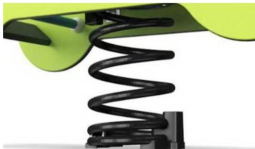
Пружины КОМПАΝ изготовлены из высококачественной пружинной стали в соответствии с EN10270. Пружины очищаются путем фосфатирования перед нанесением эпоксидной грунтовки и полиэфирного порошкового покрытия. Пружины фиксируются уникальными противозадирными фитингами для максимальной безопасности и длительного срока службы.
