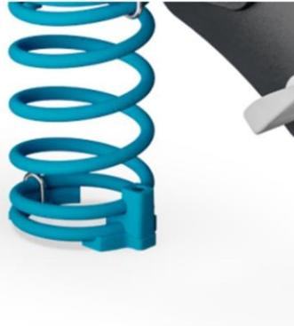
Пружины KOMPANI изготовлены из высококачественной пружинной стали в соответствии с EN10270. Пружины очищаются путем фосфатирования перед нанесением эпоксидной грунтовки и полиэфирного порошкового покрытия. Пружины фиксируются уникальными противозадирными фитингами для максимальной безопасности и длительного срока службы.
